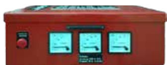
Anzeigen beleuchtet und zum Bediener hin ausgerichtet
